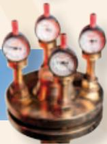
Prüfstand für Dichtungskennwerte
